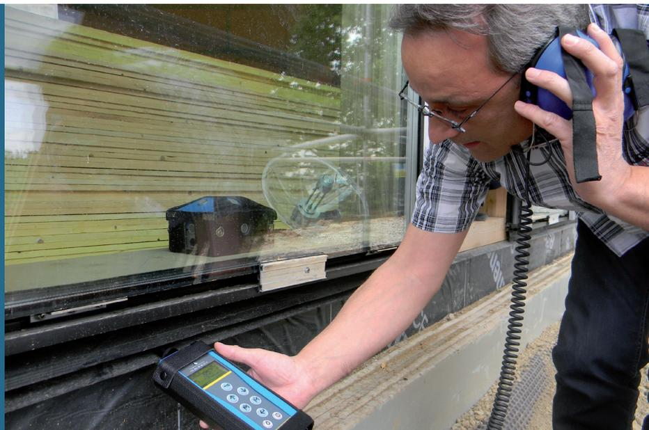
*L'étanchéité à l'air se mesure aussi à l'ultrason*
