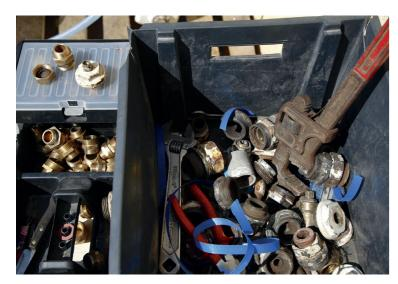
Entre les radiateurs à une, deux, trois, quatre ou six colonnes, les embouts diffèrent et il peut être fastidieux de trouver celui à la bonne taille!
