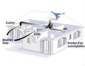
**Ventilation mécanique simple flux**
